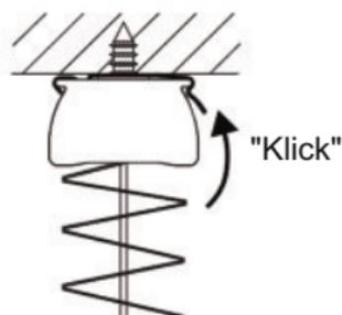
Zur **Demontage** drücken Sie die Lasche des Clips hoch, um das Profil aus dem Clip entnehmen zu können.
