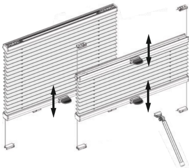
Gespannte Plisseeanlage schließt bzw. öffnet durch Verschieben des Bediengriffes.
