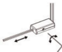
**Achtung:** Nachdem die Schnurspannung eingestellt wurde, ist es unbedingt notwendig, dass die Einstellschraube mit der gleichen Anzahl an Drehungen eingeschraubt wird, wie diese gelöst wurde.
